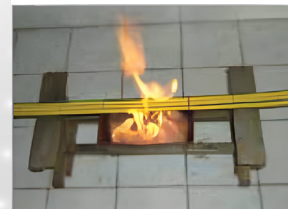
Smoke Density test BS EN 61034
